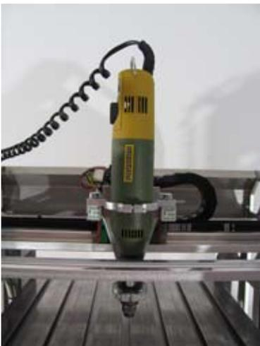
Minibohrmaschine von oben in die Halterung einschieben.
