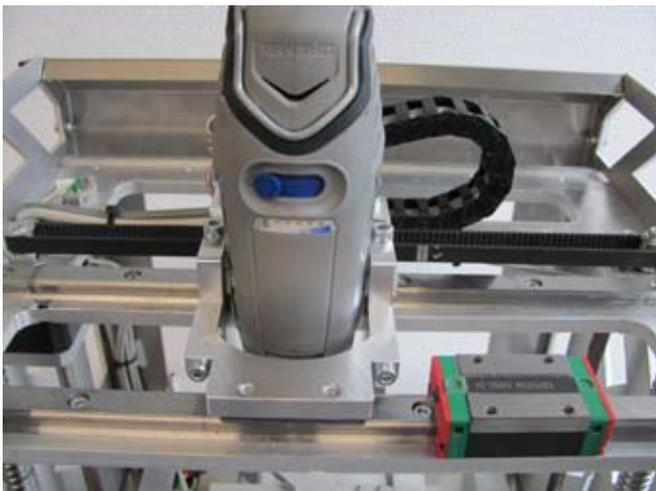
Führungsschiene mit 6 Schrauben M4x12 in die vordere Nut der X-Platte schrauben.
