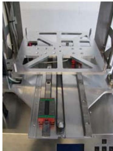
Untertisch nach hinten schieben, damit die linke Führungsschiene mit dem Führungswagen frei zugänglich ist.
