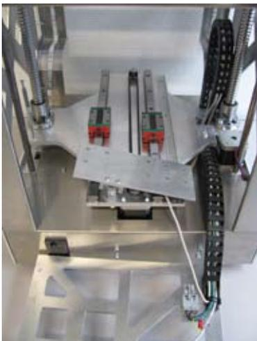
Zusätzliche Führungsschiene mit 6 Schrauben M4x12 (Best.-Nr. 1197657) in die linke Nut der Y-Platte montieren.
