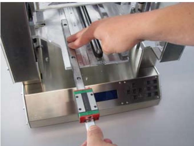
Führungsschiene mit Führungswagen in die linke Nut der Y-Platte einschieben.
