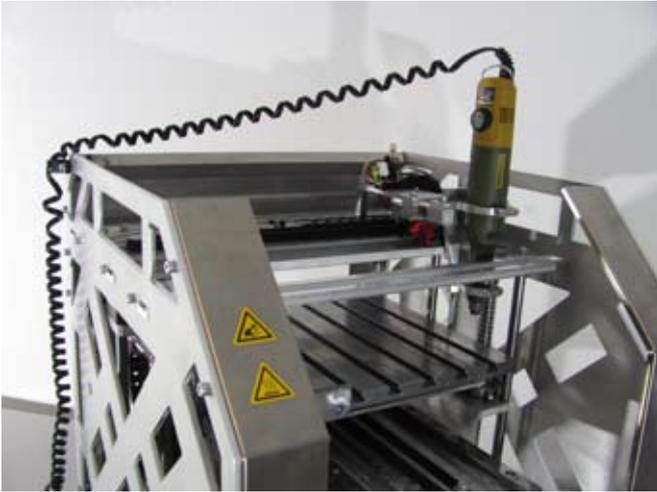
Anschlussleitung der Minibohrmaschine mit einem Kabelbinder an der Halterung für den Filamentschlauch fixieren.
