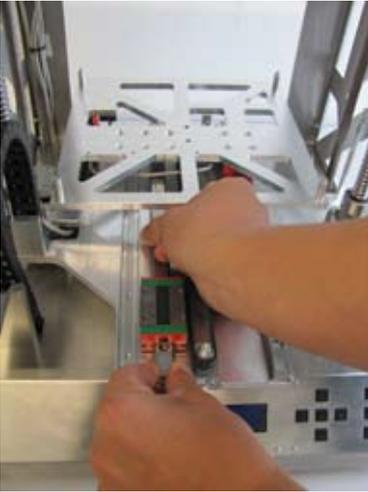
Linken Führungswagen zusammen mit der Führungsschiene aus der Nut ziehen.
