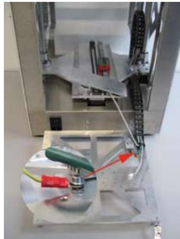
Distanzbolzen am Untertisch montieren (optionale Distanzbolzen aus Aluminium werden bei dieser Montageart empfohlen).
