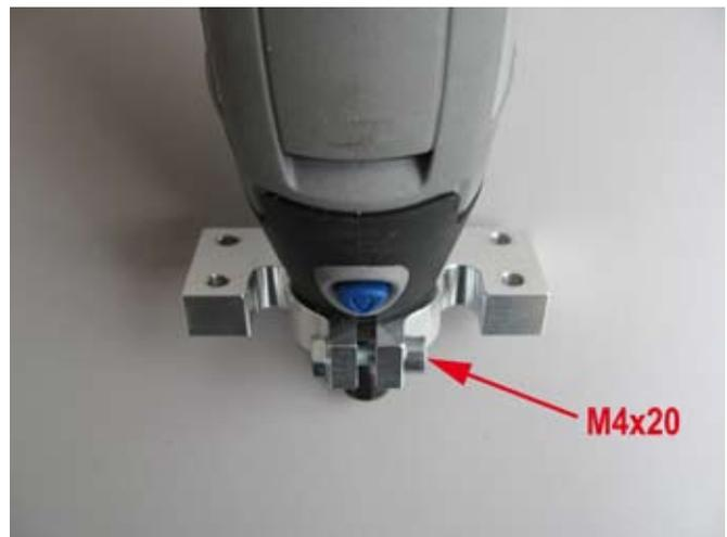
DREMEL®-Minibohrmaschine wie gezeigt in die Grundplatte montieren. Die Phase in der Montageplatte muss nach oben, zur Minibohrmaschine hin weisen.
