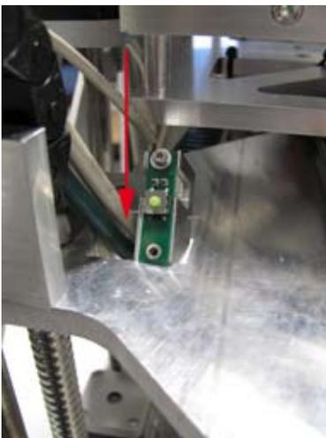
Den fertig montierten Endschalter durch die Öffnung in der Y-Platte von oben nach unten durchschieben.
