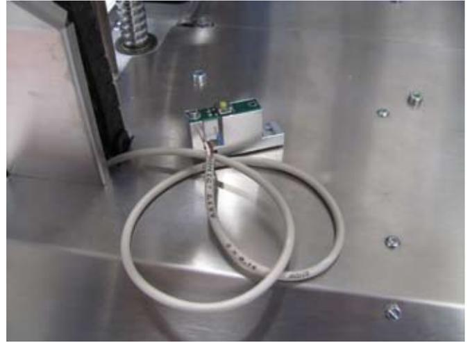
Platine an den kürzeren Strang der Doppelleitung anstecken.
