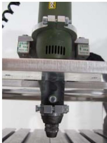
Minibohrmaschine so weit einschieben, dass die beiden Klemmzwingen eine gerade Auflagefläche haben. Klemmschrauben festziehen.
