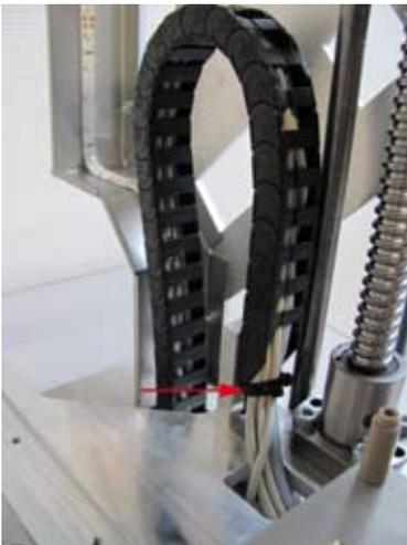
2 Kabelbinder wie gezeigt am Schleppkettenendstück befestigen.
