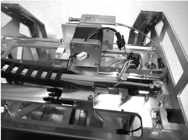
Schleppkette am Extruderwagen einrasten und die Leitungen soweit aus der Schleppkette herausziehen, dass sie sauber verlegt an den Anschlüssen des Extruderwagens angesteckt werden können.
