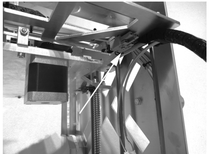
Steckverbinder für die Stromversorgung der Heizplatte mit einer Zylinderkopfschraube M3x16 an der Unterseite des Untertisches montieren.
