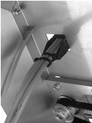
Am Schleppkettenendstück an der Bedienblende zwei große Kabelbinder (142 mm) zur Zugentlastung anbringen.
