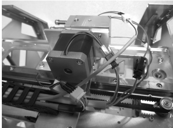
Leitungen an die jeweils passenden Stecker anschließen. Achtung: die Leitung mit den blau/roten Adern wird an den Lüfter angeschlossen. Dies ist die einzige Leitung, die aufgrund des Steckers vertauscht werden könnte.
