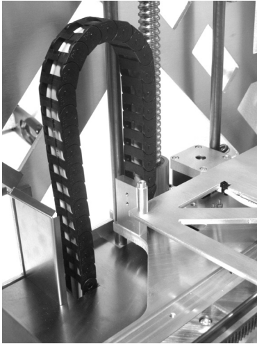
Die andere Seite der Schleppkette in das Endstück an der Bedienblende einrasten.
