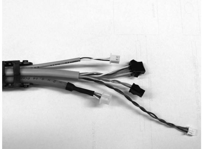
Leitungen so in die Schleppkette eindrücken, dass das Endglied mit den Nippeln zu den Leitungsenden ohne Etikett weist.
