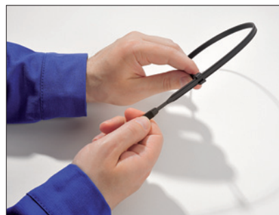
2. Das Band weiter durch den Binderkopf ziehen.
