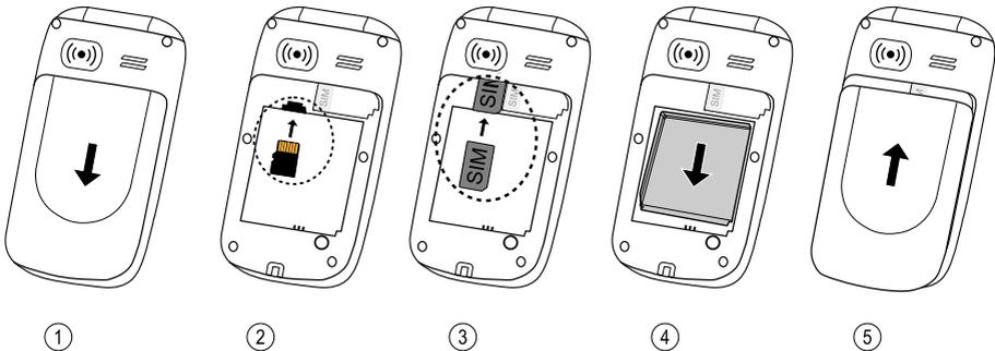
1. Entfernen Sie die Abdeckung des Akkufaches und den Akku, sofern dieser bereits eingesteckt ist.
