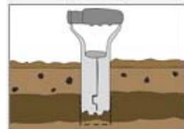
3. Die Falle in das Loch schieben und vorsichtig den Spannbugel nach oben ziehen, so dass die Fallenöffnungen mit der Gangrichtung und -höhe übereinstimmt. An der Erdoberfläche die Falle dicht mit Grass oder Blättern umschliessen, damit weder Licht noch Luft in das Loch eindringt. Die Falle ist nun einsatzbereit. Falle spätestens nach einem Tag kontrollieren. Oftmals dauert es jedoch nur wenige Stunden, bis sich ein Fingerfölg einstellt.
