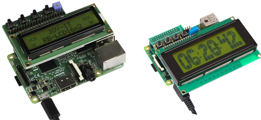
Die Buttons sind an die GPIOs des Raspberry Pis angeschlossen. Die Hintergrundbeleuchtung ist an diesem Display dauerhaft aktiviert und kann nicht abgeschaltet werden.
