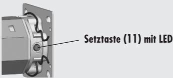
Zur Quittierung fährt der Rohrmotor kurz auf und ab und die LED in der Setztaste (11) leuchtet orange.
