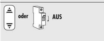
Schalten Sie zum Schluss den Rohrmotor für einige Sekunden stromlos (z. B. indem Sie die Schaltwippe des Schnurschalteretzgerätes (22) wieder in die Mittelstellung stellen). Danach ist der Rohrmotor betriebsbereit.
