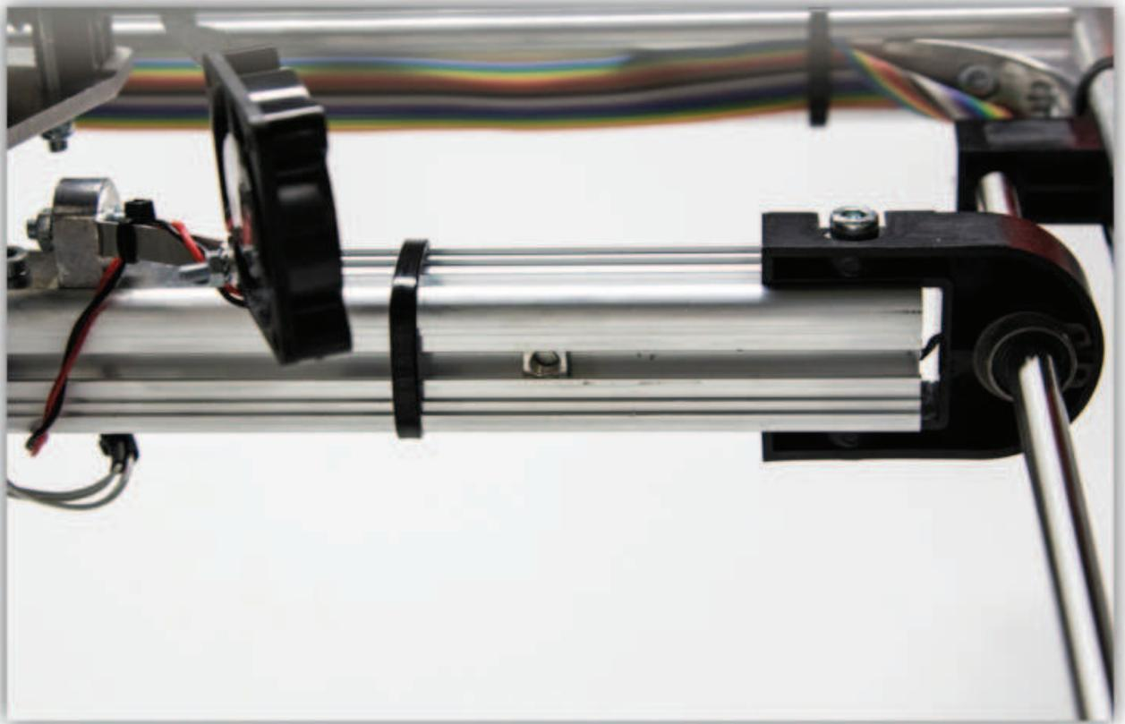
Verwenden Sie einen Sechskantschlüssel, um die Vierkantmutter in die Position der vorhin entfernten Schraube zu bringen.
