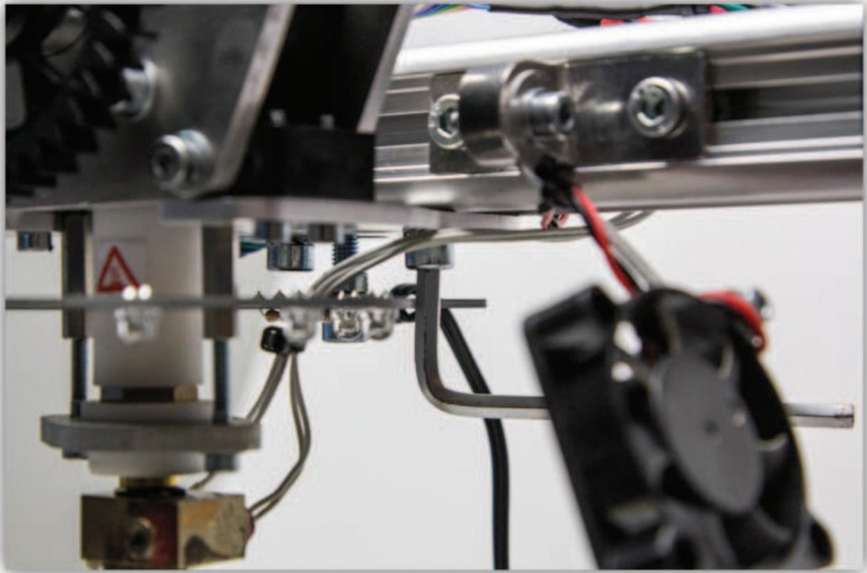
Befestigen Sie die Kabel des VM8202 mit Kabelbinder am Chassis.
