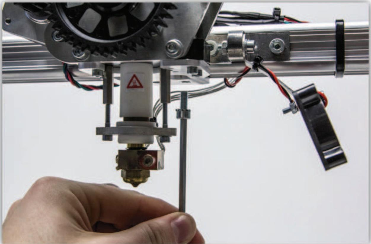
Schieben Sie die Vierkantmutter nach links bis Sie diese im mittleren Loch sehen können.
