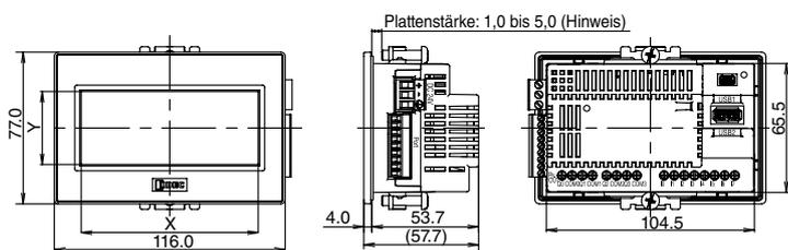
Hinweis: Wasserdichtheit nicht garantiert, abhängig von Material und Größe der Frontplatte.
