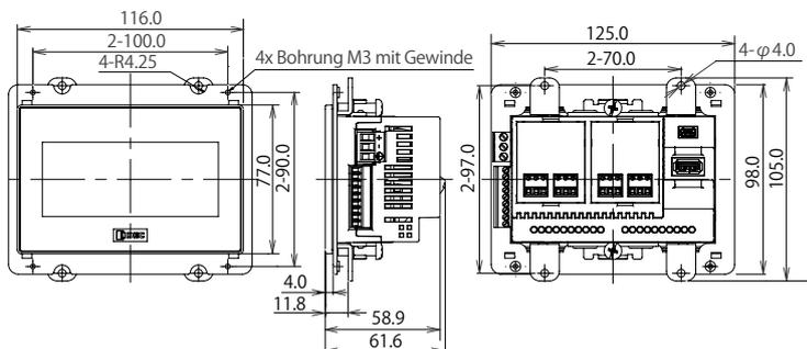
Alle Abmessungen in mm.
