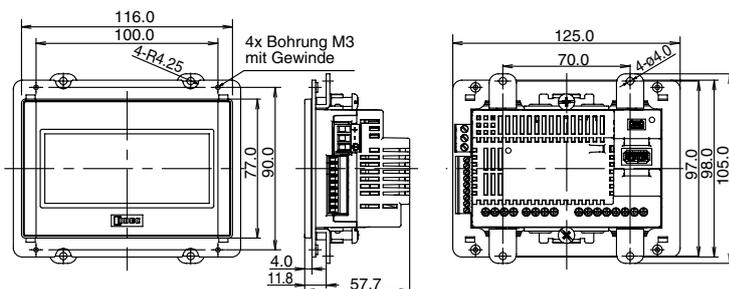
Touch (Modell mit Display)/Modell mit Transistorausgängen (FT1A-14KA-\* / FT1A-14SA-\*)
