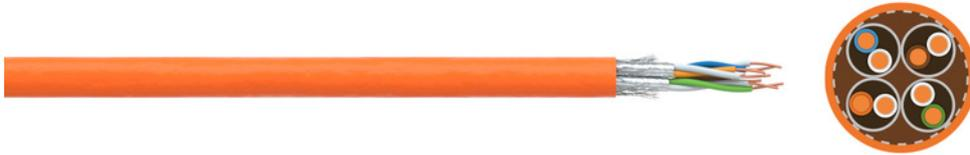
**Verwendung:** Zur Verbindung von EDV-Systemeinheiten im arbeitsplatznahen Bereich (Tertiärbereich), wie zwischen Etagenverteilern und Arbeitsplatz bis 1000 MHz (Kategorie 7+). Es entspricht hinsichtlich Funkstörungen (EMV) den Anforderungen der EN 55022 und den Richtlinien der europäischen Postverwaltung. Zusätzlich bietet das verzinnte Schirmgeflecht einen störstrahlensicheren Übergang zu geschirmten Datensteckern.
