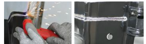
STAHL : 6 mm max ALU : 4 mm max (Schnittgeschwindigkeit = 20 cm /min mit 20A)
