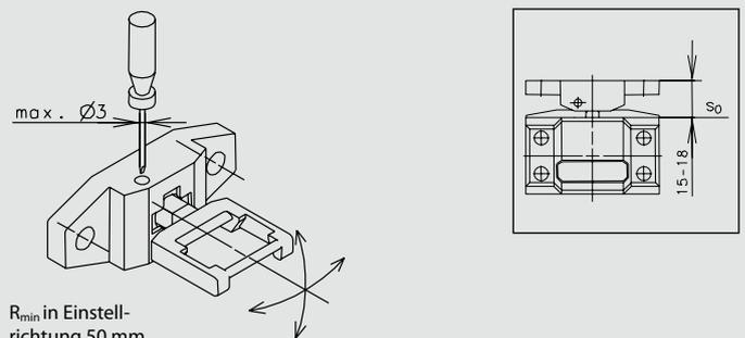
$R_{min}$  in Einstellrichtung 50 mm
