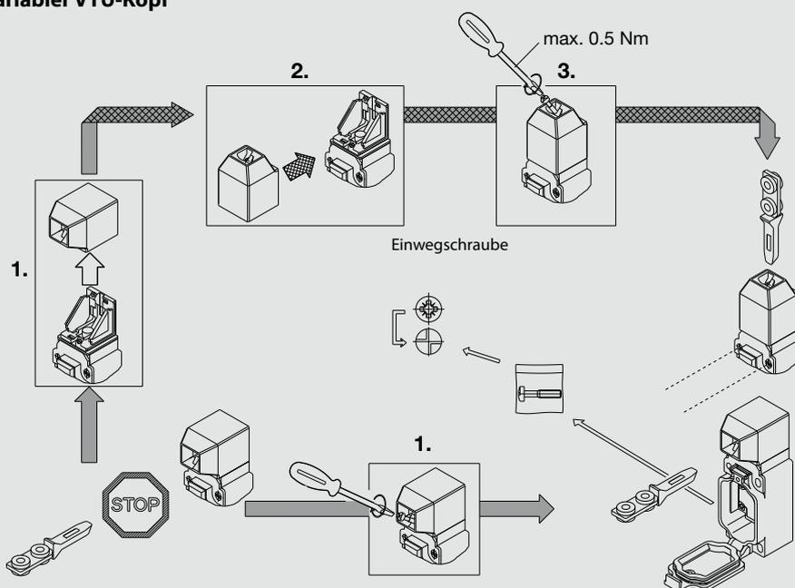
Umsetzen des Betätigungskopfes auf wahlweise horizontale bzw. vertikale Betätigungsrichtung ergibt 8 Anfahrrichtungen für den Betätiger.
