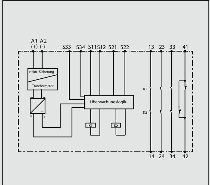
Die BERNSTEIN AG liefert Ihnen vom Sicherheitsschalter bis zum Sicherheitsrelais das komplette Programm für Ihre Applikationen. Unsere SCR Sicherheitsrelais dienen der sicheren Auswertung von Signalen, wie sie beispielsweise von BERNSTEIN Positionsschaltern, Sicherheitsschaltern, -zuhaltungen, -seilzugschaltern, -sensoren oder 2-Hand-Bedienungen erzeugt werden.
