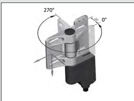
Dem SHS3 sind in puncto Flexibilität bei der Montage fast keine Grenzen gesetzt: Das SHS3 erlaubt nicht nur Front- und Innenmontage, Rechts- und Linksanschlag oder die frei wählbare Richtung des elektrischen Anschlusses. Durch den über 270° einstellbaren Schaltpunkt findet das Schaltscharnier jetzt auch dort seinen Einsatz, wo die Montage zuvor unmöglich war.
