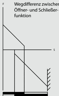
Bild 2 zeigt die Kontaktkraft im Verlauf eines Schaltspiels für ein Sprungschaltglied mit Überlappung.
