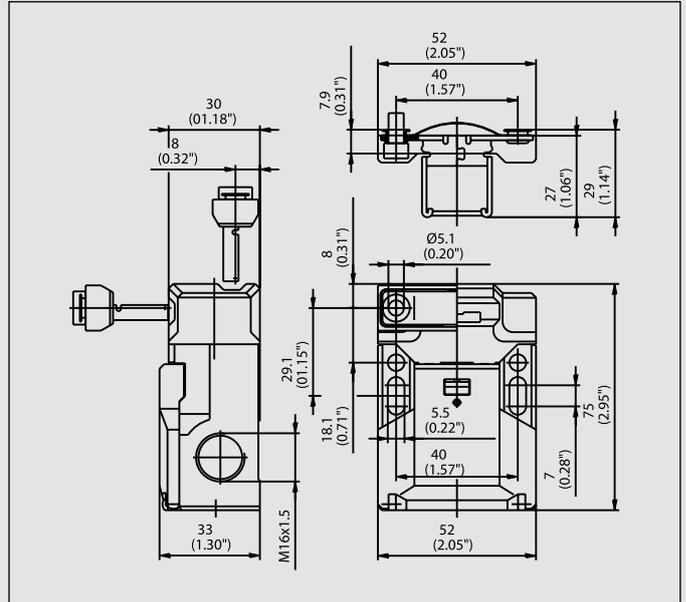
Der Sicherheits-Positionsschalter SKC ist in Bezug auf die Länge die 15 mm kompaktere Variante des SK. Damit ist er bei engen Einbaubedingungen bestens geeignet.
