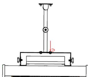
2. Montieren Sie die Wandhalterung mit den 4 M6x50 mm Schrauben an der Wand.
