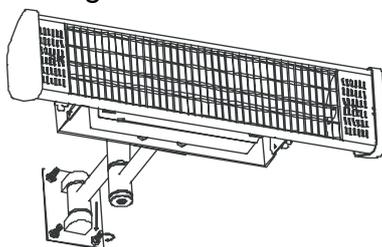
3. Den Reflektor anschliessend wunschgemäß in einem horizontalen Winkel zwischen 30° und 45° einstellen. Ziehen Sie die entsprechenden Schrauben nach dem Ausrichten fest an.
