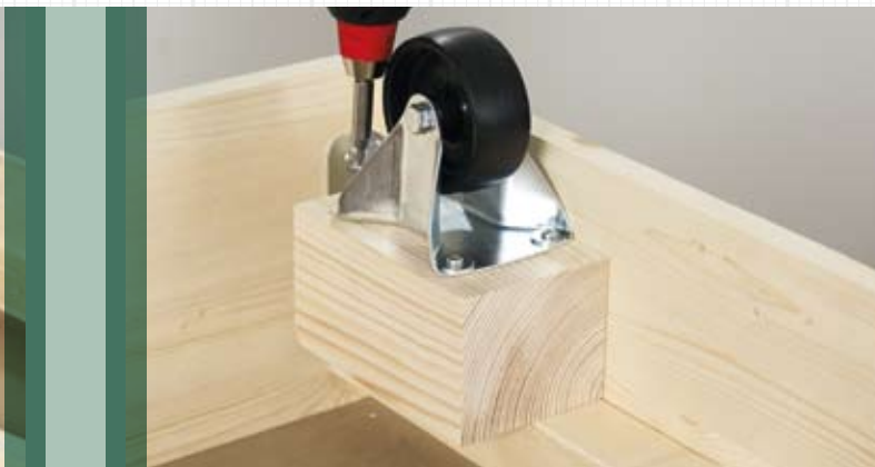
3. Untergestell: Rollen montieren
