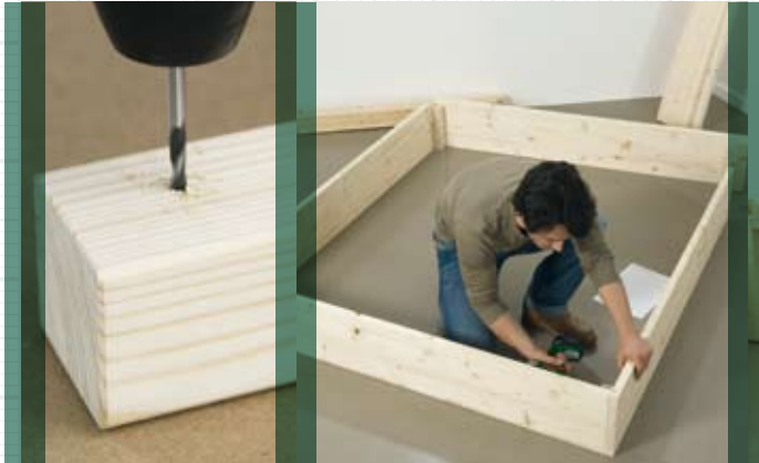
1. Rahmenseiten mit den Schraubleisten verbinden
