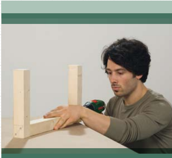
1. FüÙe und Querverbinder zu Untergestellen verschrauben
