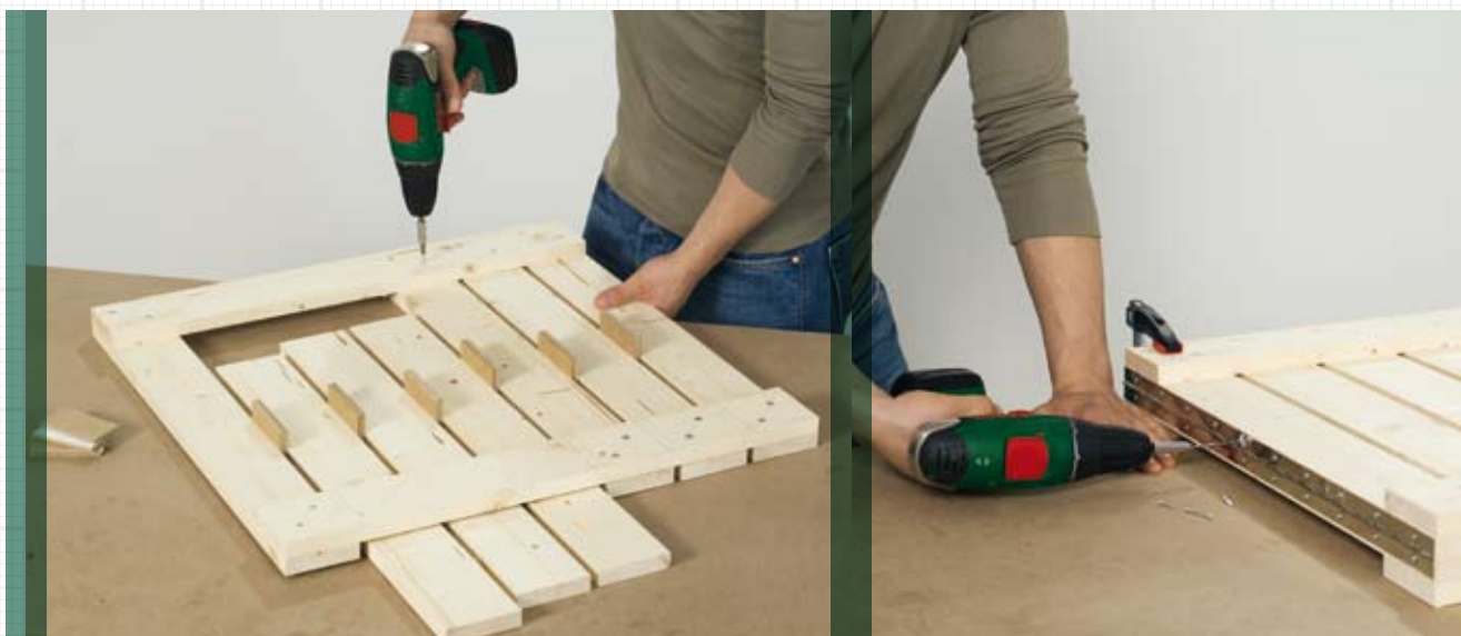
4. Lattenrostteile verschrauben und mit Klavierband verbinden
