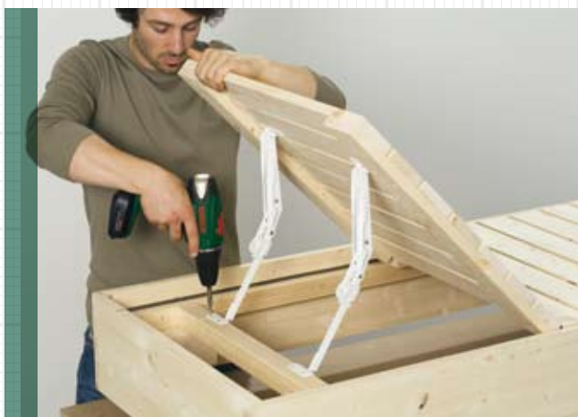
5. Befestigung der Hochstellstütze mit gleichzeitiger Montage der Befestigungsleiste
