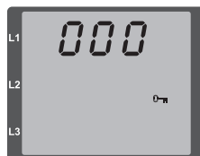
Abb. Passwortabfrage Wurde ein Passwort gesetzt, kann über die Tasten 1 und 2 dieses eingegeben werden.
