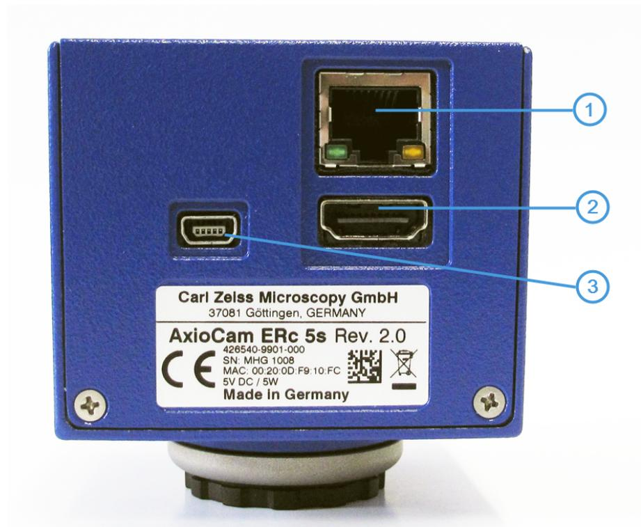
Abb. 2: Kameraanschlüsse
