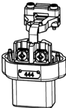
Gerätesteckdose T 155, mit Schutzkontakt. ähnl. EN 60 320, Normblatt C 21. Für Heissgeräte bis 100 °C Dauergebrauchstemperatur. Vorsatzstück hergestellt aus Silikon, Griffstück aus Perbunan, Winkelausführung.
