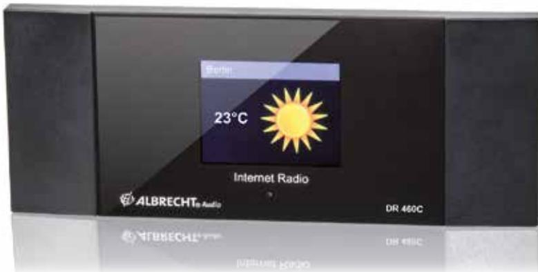
Der ALBRECHT DR 460 C Wireless LAN Internet-Tuner ist ein Adapter zum Anschluss an HiFi Anlage oder Lautsprechersysteme zum Empfang von über 25.000 Internet-Radiostationen weltweit. Sie benötigen nur eine Internetverbindung und einen WLAN-Router.
