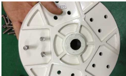
Führe die Sechskantschraube von hinten durch die Nabenscheibe
