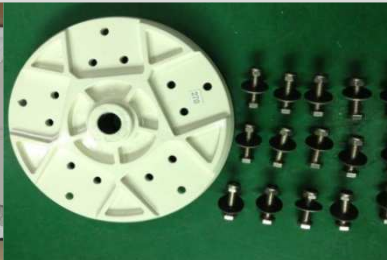
Nabenscheibe, Sechskantschraube, Unterlagscheibe selbstsichernde Mutter
