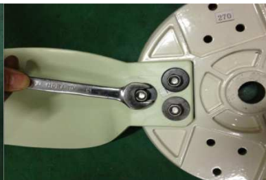
Nabenscheibe, Sechskantschraube, Unterlagscheibe selbstsichernde Mutter
