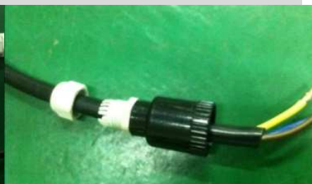
Führe das Kabel durch die Kappe
