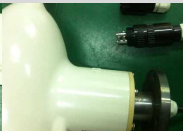
Schraube die Kappe der Anschlussklemme ab
