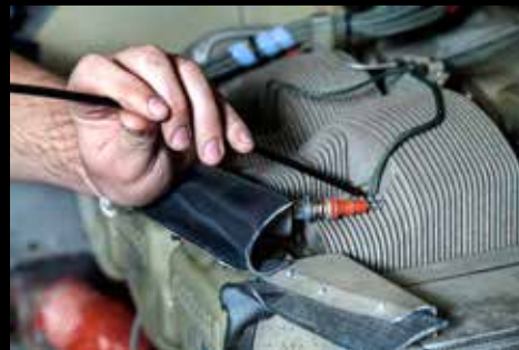
Inspektion eines Zylinders in einem Flugzeugmotor mit VSA2-1M
