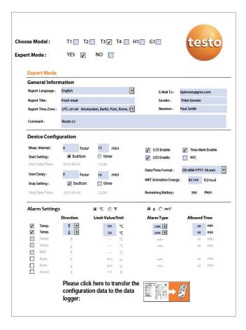
Zum Konfigurieren eines testo 184 Loggers muss keine Software am PC oder Notebook installiert werden. Das PDF-Konfigurationstool ist auf dem Logger selbst gespeichert und kann mit einem einfachen Doppelklick geöffnet werden.
