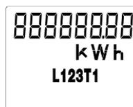
Verlassen der Grundanzeige mit der ersten Betätigung *Lang* der linken oder der rechten Taste – hier die Grundanzeige im Zählerstillstand mit oberem Bedienpfeil
