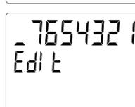
Im Beispiel neu eingestellte M-Bus-Sekundäradresse mit dem Wert 87654321 in der oberen Zeile und zugehörige Kennzahl 0.0.2 in der unteren Zeile
