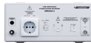
V-Zweileiter Netznachbildung zur Messung leitungsgebundener Störungen LISN HM6050-2
