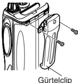
Falls erforderlich, befestigen Sie den Gürtelclip mit den beiden mitgelieferten M3 x 8 mm-Schrauben.
