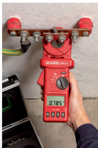
Messung des Erdschleifenwiderstandes eines Anlagenerdes
