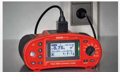
IT 115 bei der Schleifenimpedanzmessung ohne RCD-Auslösung
