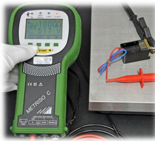
**Messungen des Isolationswiderstandes** und der Durchschlagsfestigkeit von Spulenwicklung und Anschlußleitungen geben in ausfallkritischen Applikationen die notwendige Sicherheit. Red Magnetism erledigt solche Prüfungen stichprobenartig oder für die Gesamtmenge auf Kundenwunsch im eigenen Meßlabor.
