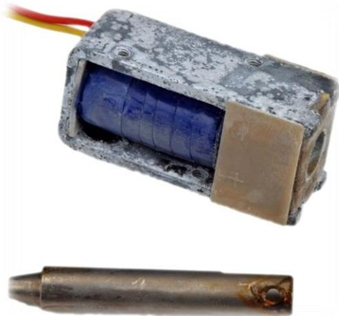
Ein monostabiler Bügelmagnet nach 5 Monaten Einsatzdauer in einem Kiesquetschwerk. Die hohe Luftfeuchte in Verbindung mit aggressiven Zuschlagstoffen hat die Oberflächen bereits deutlich angegriffen. Zeitweilig klemmte der Stößel im Kern fest, was zum sporadischen Versagen des Mischdosierers führte. Ein völliger Ausfall mit Betriebsstillstand wäre in Kürze die Folge gewesen.
