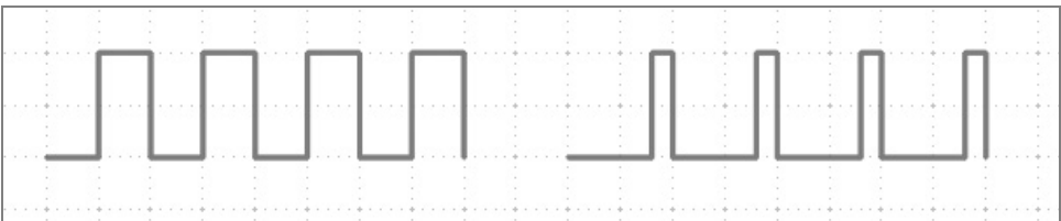
Abb. 6.1: Links: Tastverhältnis 50 % - rechts: Tastverhältnis 20 %.
