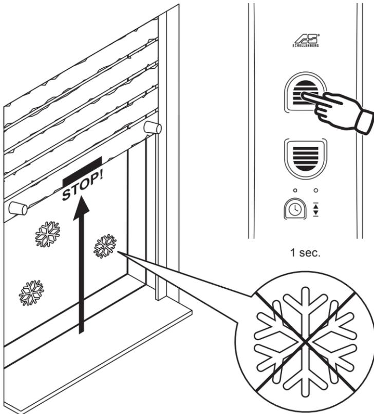
Blockiert der Rollladen während der Auffahrt (z.B. durch Vereisung), schaltet der ROLLODRIVE 35 ab. Beseitigen Sie die Überlastungsursache.
