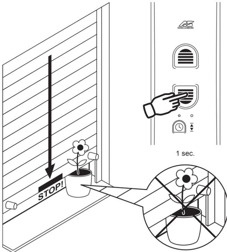
Trifft der Rollladen während der Abfahrt auf ein Hindernis, schaltet der ROLLODRIVE 35 ab. Fahren Sie den Rollladen nach oben und entfernen Sie das Hindernis.
