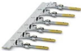
Crimpkontakt, gerollt, Einzelkontakt, Kontaktdurchmesser: 1 mm, Crimpbereich: 0,22 mm<sup>2</sup>...0,56 mm<sup>2</sup>
