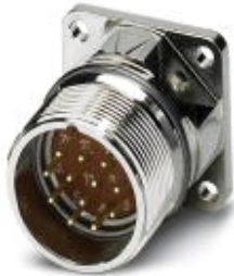
Gerätesteckverbinder Vorderwand, gerade, Schraubverriegelung, M23, Polzahl: 12, Kontaktart: Stift, Crimpanschluss, O-Ring axial, 4xØ3,2, geschirmt: ja
