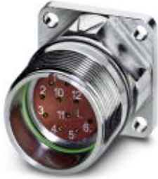
Gerätesteckverbinder Vorderwand, gerade, Schraubverriegelung, M23, Polzahl: 12, Kontaktart: Buchse, Crimpanschluss, O-Ring axial, 4xØ3,2, geschirmt: ja
