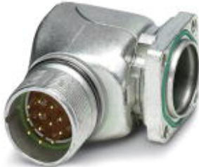
Gerätesteckverbinder Vorderwand, gewinkelt drehbar, Schraubverriegelung, M23, Polzahl: 17, Kontaktart: Stift, Crimpanschluss, O-Ring axial, 4xØ3,2, geschirmt: ja, Flanschmaß: 26 mm x 26 mm
