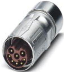
Kabelsteckverbinder, gerade, SPEEDCON-Verriegelung, M17, Polzahl: 8, Kontaktart: Stift, Crimpanschluss, geschirmt: ja, Kabeldurchmesser: 5 mm...9 mm
