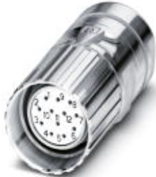
Kabelsteckverbinder, gerade, geschirmt: ja, Schraubverriegelung, M23, Polzahl: 17, Kontaktart: Buchse, Crimpanschluss, Kabeldurchmesser: 3 mm ... 14,5 mm
