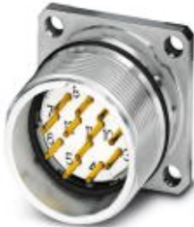
Gerätesteckverbinder Vorderwand, gerade, geschirmt: ja, SPEEDCON-Verriegelung, M23, Polzahl: 17, Kontaktart: Stift, Crimpanschluss, Flachdichtung, 4xØ3,2
