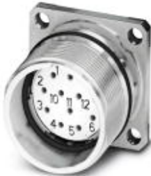
Gerätesteckverbinder Vorderwand, gerade, geschirmt: ja, SPEEDCON-Verriegelung, M23, Polzahl: 17, Kontaktart: Buchse, Crimpanschluss, Flachdichtung, 4xØ3,2
