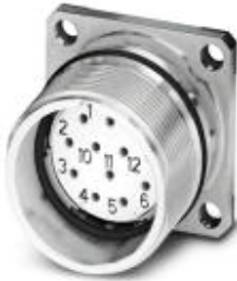
Gerätesteckverbinder Vorderwand, gerade, geschirmt: ja, SPEEDCON-Verriegelung, M23, Polzahl: 12, Kontaktart: Buchse, Crimpanschluss, Flachdichtung, 4xØ3,2
