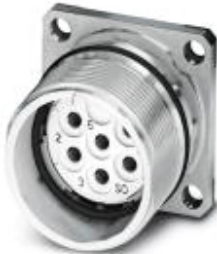
Gerätesteckverbinder Vorderwand, gerade, geschirmt: ja, SPEEDCON-Verriegelung, M23, Polzahl: 8+1, Kontaktart: Buchse, Crimpanschluss, Flachdichtung, 4xØ3,2
