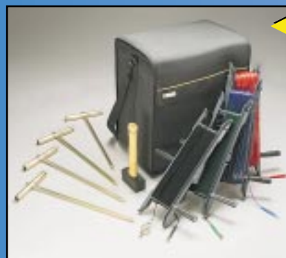
Zubehör-Set für Erdungs- und Bodenwiderstandsmessung „Prestige“ P01.1018.25
