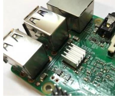
Mit leichtem Druck den Kühkörper auf den Chip drücken.
