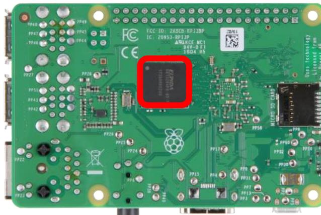
Je nach Gehäuse-Type ist eine Befestigung des Kühkörpers auf der Unterseite des Raspberry Pi nicht möglich.
