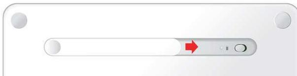
Schieben Sie den Batteriefachdeckel in Richtung des Ein-/Ausschalters und nehmen Sie ihn ab.
