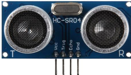
Das Ultraschallmodul arbeitet in einem Distanzrahmen von 2 bis 450 cm. Die maximale Abweichung beträgt hierbei gerade einmal 2 % des ermessenen Wertes. Durch die kleinen Abmessungen und die hohe Verarbeitungsqualität ist dieses Modul auch ideal für mobile Einsätze geeignet.
