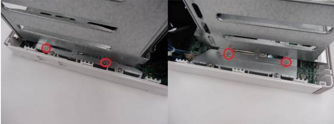
7. Bei einem NAS mit 4 Einschüben müssen Sie auch die zwei Schrauben oben am Festplattenkäfig entfernen.
