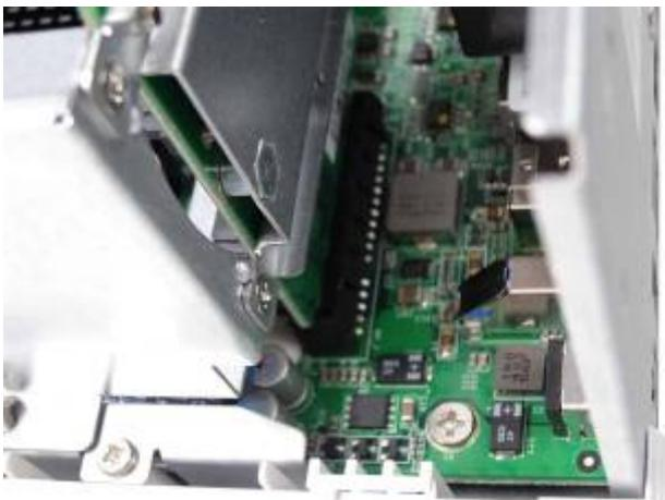
9. **Achten Sie immer darauf, dass ein Speichermodul im primären Steckplatz (rot) installiert ist. Andernfalls kann das System nicht starten.** Bei der Installation von zwei Speichermodulen achten Sie bitte darauf, dass sie dieselbe Größe haben, und benutzen Sie idealerweise denselben RAM-Typ für beide Speichersteckplätze. Die maximal unterstützte Speichergröße beträgt 8 GB kombiniert.
