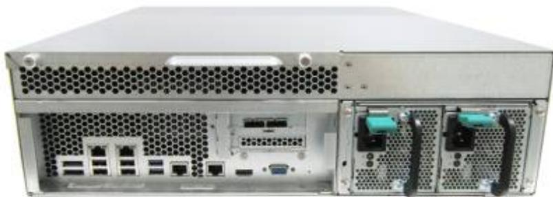
11. Schließen Sie das Netzteil und die Kabel an den NAS an.
