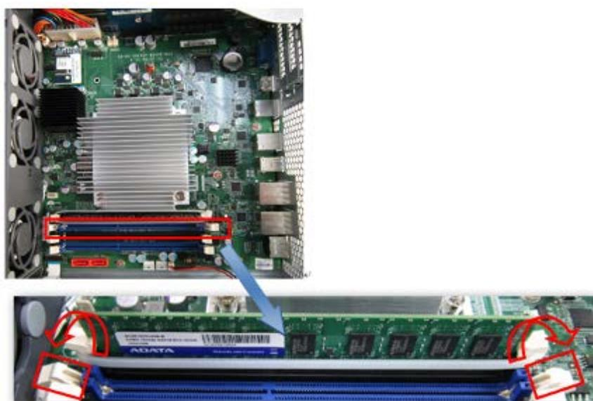
4. Ergreifen Sie den Rand des RAM-Moduls. Bringen Sie die Kerbe am goldenen Rand des RAM-Moduls mit der Kerbe im RAM-Steckplatz in Übereinstimmung. Schieben Sie das RAM-Modul bis zum Anschlag in den RAM-Steckplatz.
