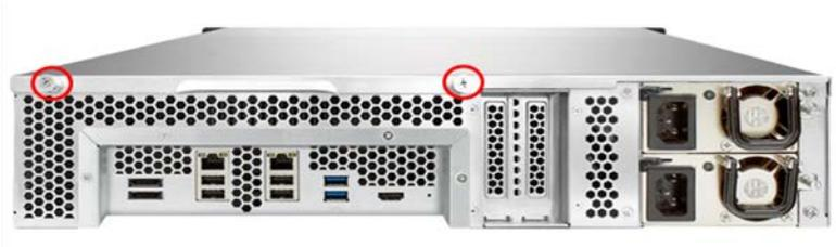
4. Ergreifen Sie die Vertiefung an der oberen Abdeckung. Nehmen Sie die obere Abdeckung mit beiden Händen ab.
