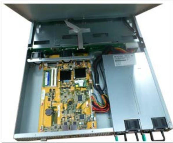
5. Schieben Sie das Speichermodul in einem 45-Grad-Winkel (circa) in den Steckplatz.
