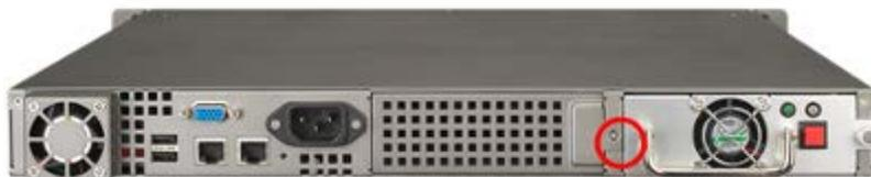
3. Installieren Sie das Netzteil; drücken Sie es bis zum Anschlag hinein.
