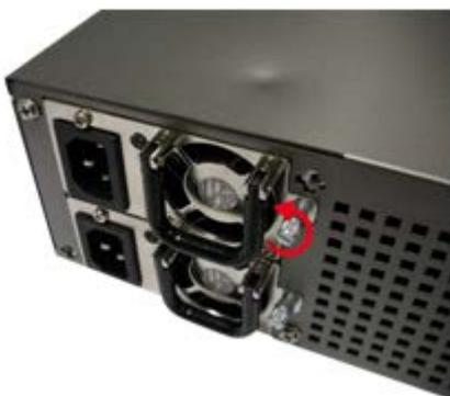
3. Trennen Sie das defekte Netzteil.
