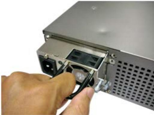
4. Stecken Sie das neue Netzteil in das NAS ein.
