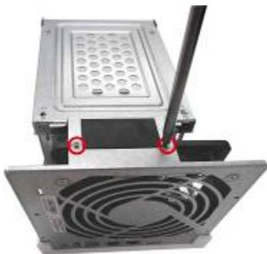
8. Entfernen Sie den Festplattenkäfig vorsichtig aus dem NAS, indem Sie ihn aus seinem Steckplatz herausheben.
