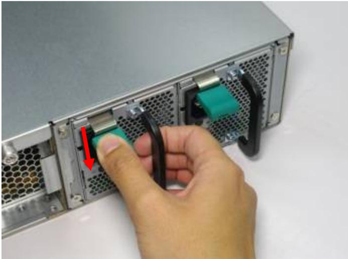
3. Ziehen Sie das defekte Stromversorgungsmodul heraus.
