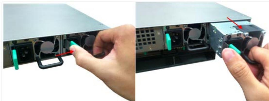
3. Setzen Sie ein neues Netzteil ein, drücken Sie es bis zum Ende hinein.
