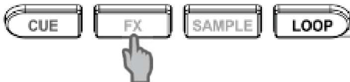
7.2 Drücken Sie das/die **Pad(s) 1, 2** und/oder **3**, um die entsprechenden Effekte an- oder auszuschalten. Drücken Sie das **Pad 4**, um das MacroFx (eine Kombination von Effekten) an- oder auszuschalten.
