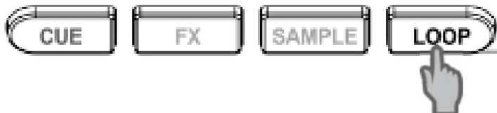
Drücken Sie die Pads 1 bis 8, um einen Loop mit einer voreingestellten Größe und passend zum Takt des (vertikale Balken = BPM) Tracks zu aktivieren.
