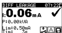
Abbildung 5.29: Beispiel für das Ergebnis einer Differential-Leckstrommessung
