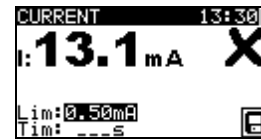
Abbildung 5.45: Beispiel für das Ergebnis einer Zangenstrommessung
