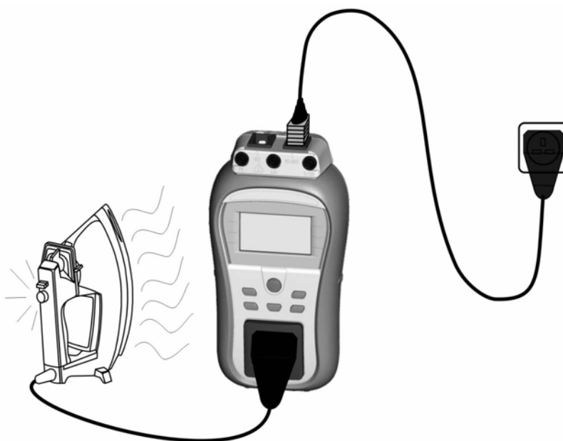
Abbildung 5.28: Messung des Differential-Leckstroms
