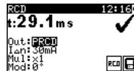
Abbildung 5.37: Beispiele eines (P)RCD-Prüfungsergebnisses
