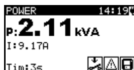
Abbildung 5.40: Beispiel für das Ergebnis einer Scheinleistungsmessung
