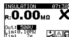
Abbildung 5.11: Beispiele für Ergebnisse einer Isolationswiderstandsmessung
