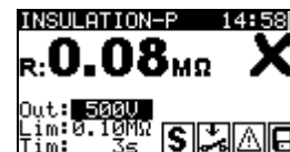
Abbildung 5.15: Beispiel für das Ergebnis einer Messung des Isolationswiderstandes - P
