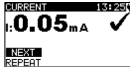
Abbildung 6.48: Ergebnisbildschirm für die Zangenstrom-Messung
