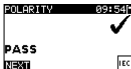
Abbildung 6.44: Ergebnisbildschirm der Polaritätsprüfung
