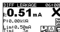
Abbildung 5.29: Beispiel für das Ergebnis einer Differential-Leckstrommessung
