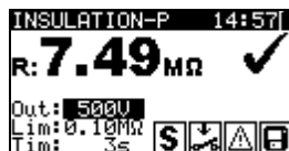
Abbildung 5.15: Beispiel für das Ergebnis einer Messung des Isolationswiderstandes - P
