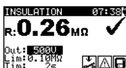
Abbildung 5.11: Beispiele für Ergebnisse einer Isolationswiderstandsmessung
