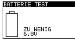
Bild 1.1: Anzeige „Batterie entladen“
