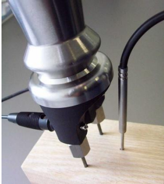
Hohlhammerlektrode GHE91 mit Temperaturfühler GTF38
