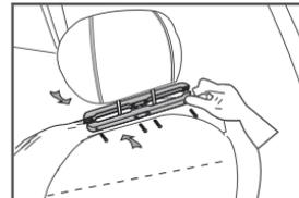
3. Setzen Sie die Halterung an den Trägern der Kopfstütze an und schrauben Sie sie fest.
