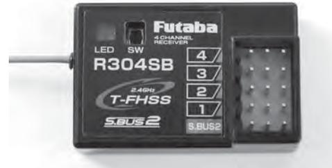
T-FHSS Empfänger R304SB 2,4 GHz, 4-Kanal Telemetrie Empfänger
