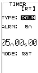
Die Abbildung zeigt die Display Darstellung bei den Einstellungen für die abwärtszählende Stoppuhr. Die Zeit wird in Minuten, Sekunden und 1/100-Sekunden angezeigt.
