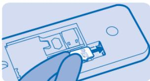
6. Beachten Sie die Anschlusskontakte des Akkus und setzen Sie den Akku ein.
