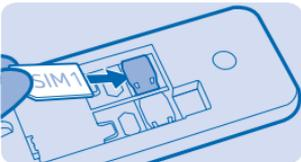
4. Um eine zweite SIM-Karte einzusetzen, schieben Sie die SIM-Karte mit der Kontaktfläche nach unten hinein.
